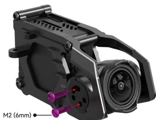
6. 将O3 Air Unit与摄像头的连接线绕3圈。然后把摄像头安装至两个镜头减震硅胶中间。并用4颗M2\*6mm（半圆头内六角）螺丝固定。
