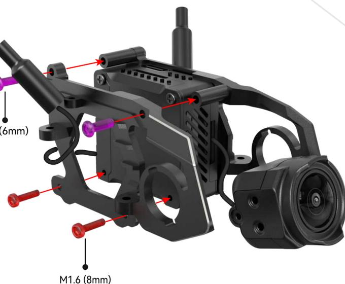
4. 将另一侧铝合金的4个安装孔对准铝柱及O3 Air Unit的安装孔，并用2颗M2\*6mm（半圆头内六角）与2颗M1.6\*8mm（杯头内六角）螺丝固定。
