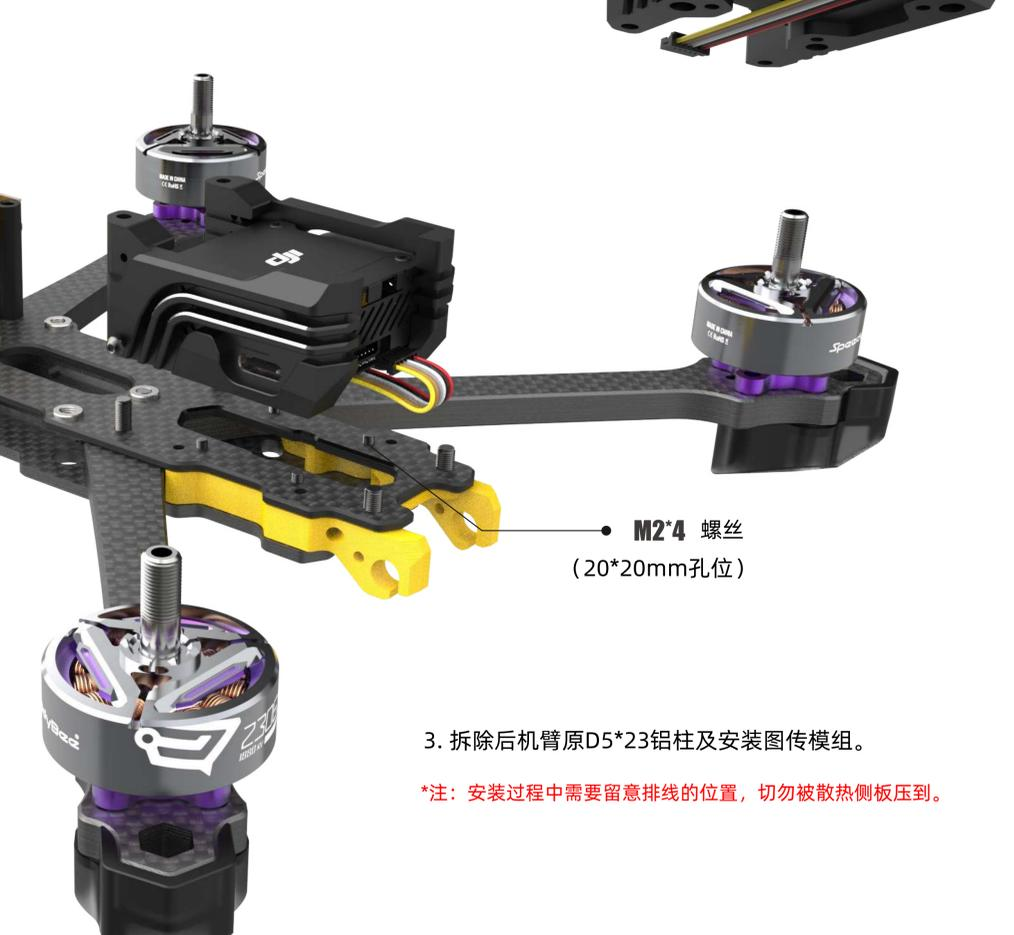
3. 拆除后机臂原D5\*23铝柱及安装图传模组。
